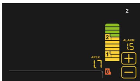
**Апекс локатор.** Расстояние до апекса выводится на дисплей при инструментальной обработке корневого канала. Приближение апекса проверяется программой ENDO. Как только достигнут апекс, функция Apex-Stop останавливает вращение микромотора.
