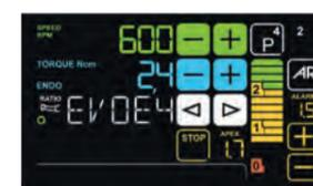
**Эндодонтия.** В данном режиме опциональная встроенная эндодонтическая система оптимизирует эргономику лечения корневых каналов. Включает в себя микромотор, функции Autostop, Autoreverse и Autoforward и электронный апекс локатор. Во время эндодонтического
